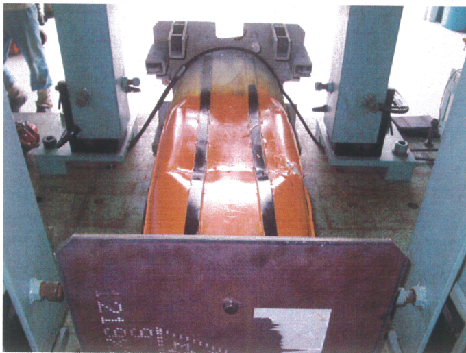
写真8 試験後の状況 (高さ 8m)
